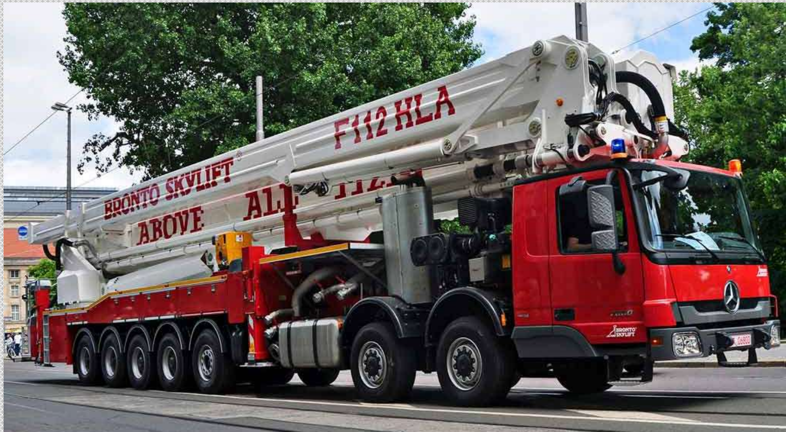
Пожарный подъёмник Bronto Skylift типа F 112 HLA, установленный на автошасси, с рабочей высотой 112 метров
